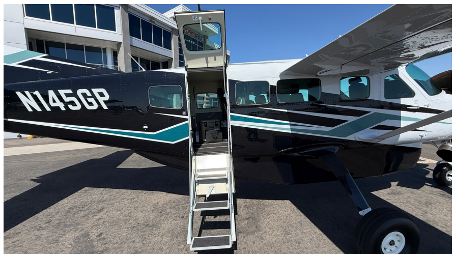
Air Stair Door
